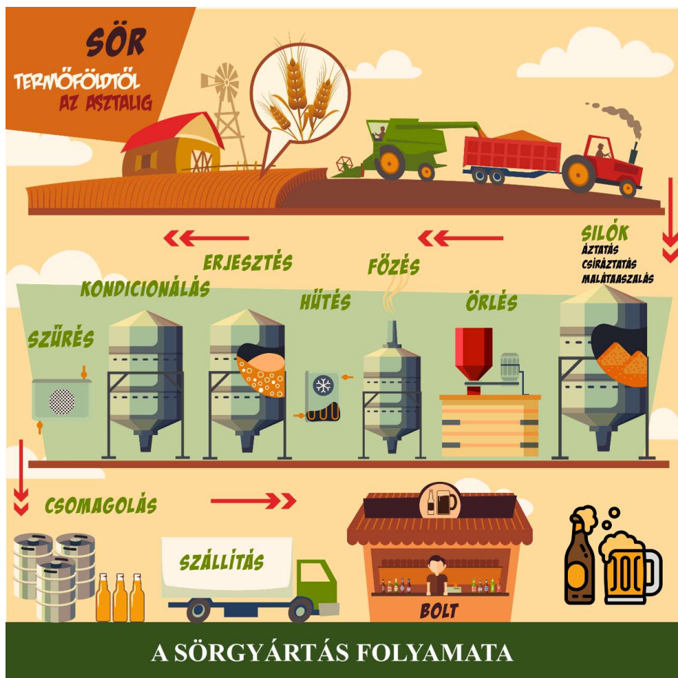
3.ábra: Sörgyártás folyamata
