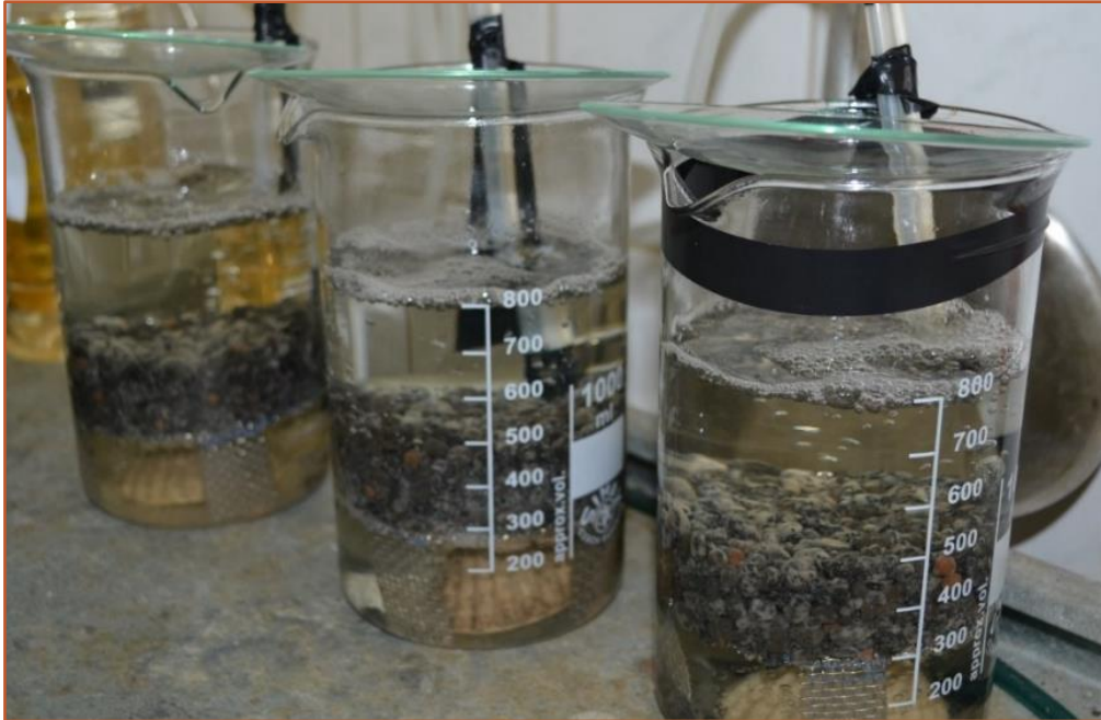
20. ábra A minireaktorok felépítése
