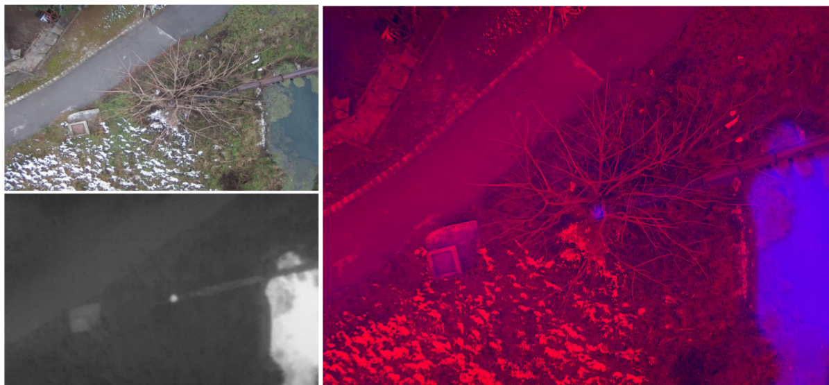
4.3. ábra. Színes és hőkép valamint feldolgozás során jelentkező szinkronitási hiba
