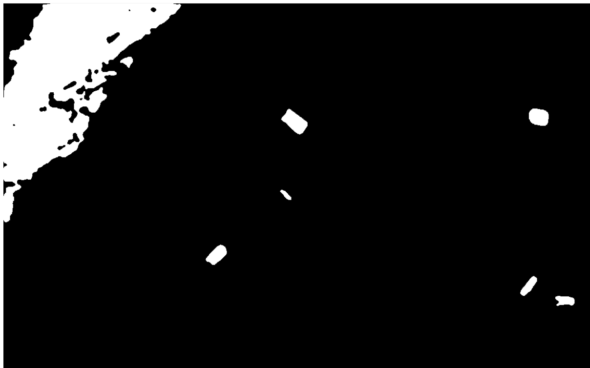
3.14. ábra. HSV színtartomány alapú medencekeresés eredményeként előállt bináris detektálási maszk eredménye median filterrel szűrve
