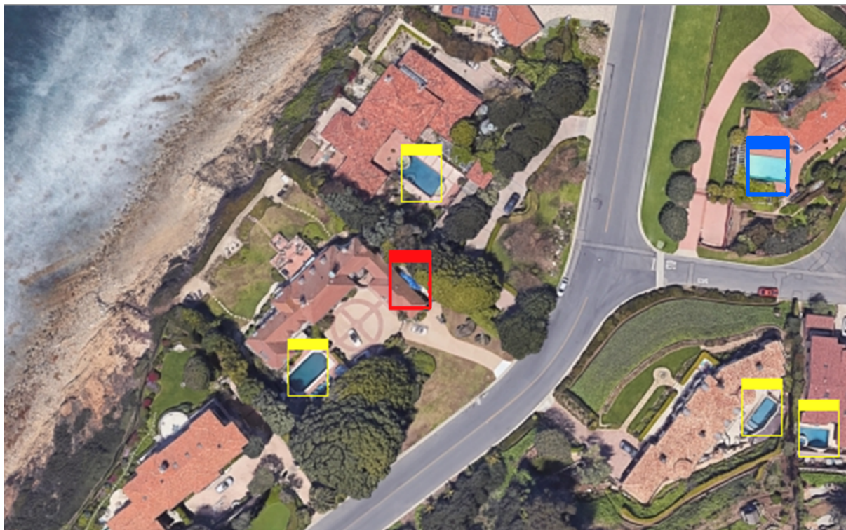
3.10. ábra. Konvolúciós Neurális hálózat hibás detektálása: piros téglalap a false-positive eredményt, míg a kék téglalap false-negative eredményt jelöli
