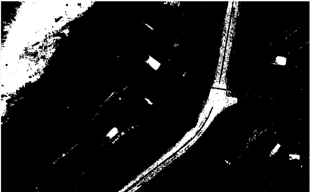
3.13. ábra. HSV színtartomány alapú medencekeresés eredményeként előállt bináris detektálási maszk, ahol a kék színnek megfelelő pixelek fehérrel jelöltek
