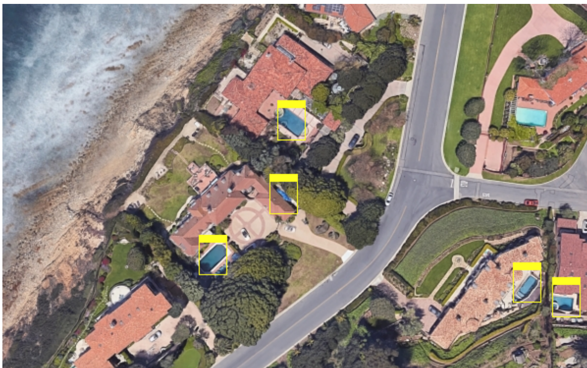
3.9. ábra. Konvolúciós neurális hálózat segítségével detektált medencék false-positive és false-negative eredményekkel
