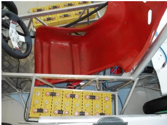
4. ábra: A beépített akkumulátor cellák
