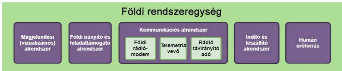
9. ábra: Drónrendszer általános földi rendszeregység felépítése [65]
