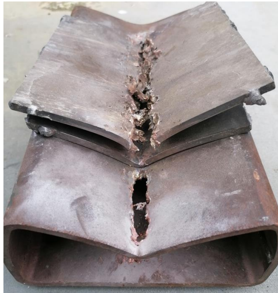
19. ábra: Hibás vágótöltet vágási teljesítményének csökkenése 84
