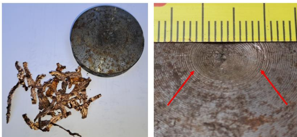
8. ábra: TKR 10x1 mm vörösréz csőben történő robbanásának stabilitás vizsgálata
