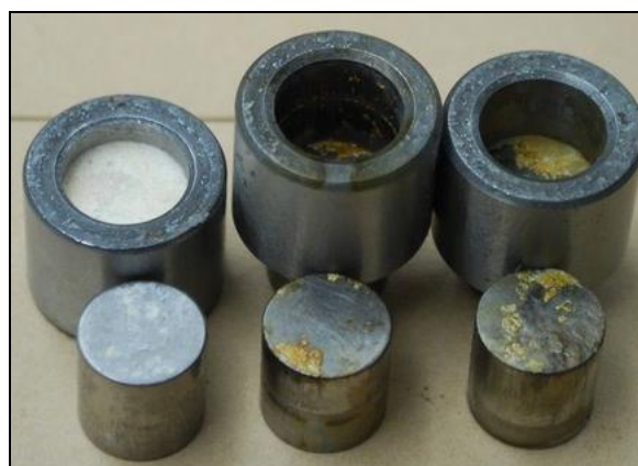
Acél hengerek és az acél gyűrű az ütészérenység vizsgálata után
