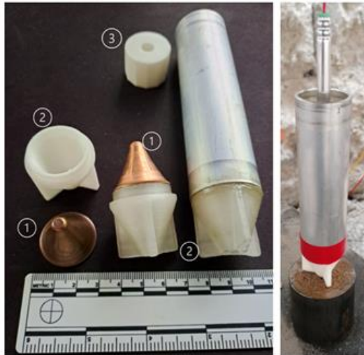
20. ábra: A kumulatív töltet részei, és az összeállított töltet a céltárgyon 86
