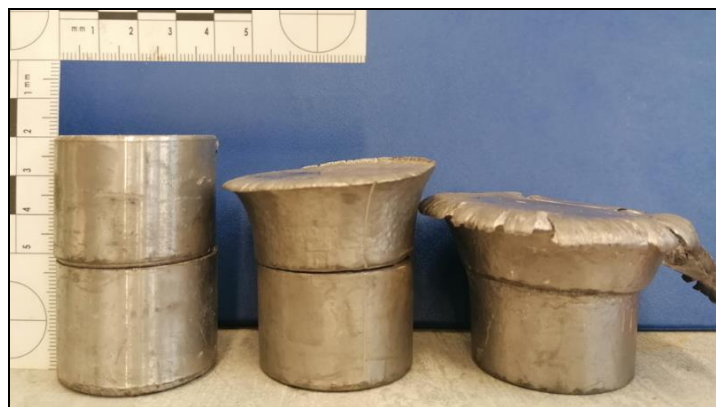
9. ábra: Hess-féle brizancia vizsgálat eredményei 64
