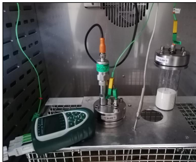
A hőállóság vizsgálat eszközei - a kép jobb oldalán a kvarchomok mint referencia anyag látható
