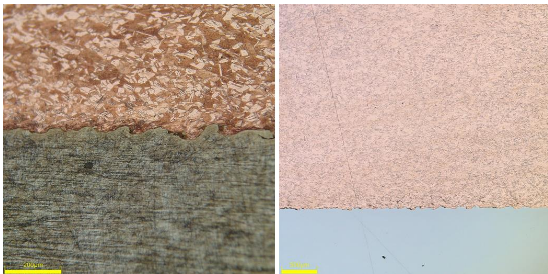
30. ábra: 200 µm (b); és 500 µm (j) felbontású felvétel a vörösréz és a KO33 acél között kialakult kohéziós kötésről 100
