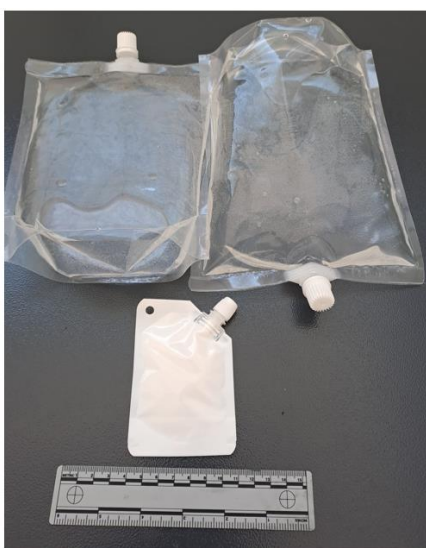
37. ábra: A robbantásra előkészített töltet, 2x1000ml vízzel 110
