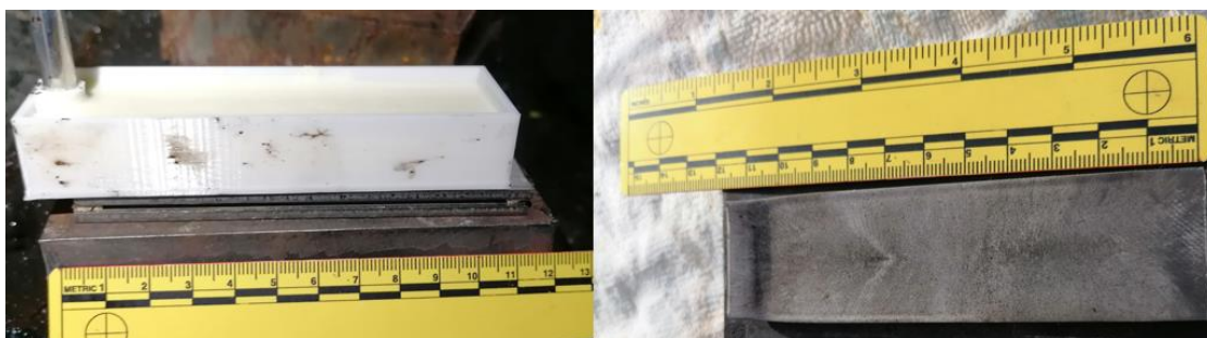
28. ábra: 3 mm vastag KO33 lemez robbantásos hegesztése 3 mm vastag KO33 lemezhez 98
