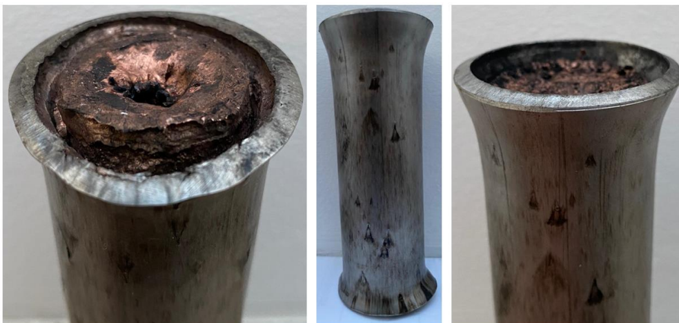
34. ábra: KO36-Vörösréz tengelyszimmetrikus plattírozott termék 106
