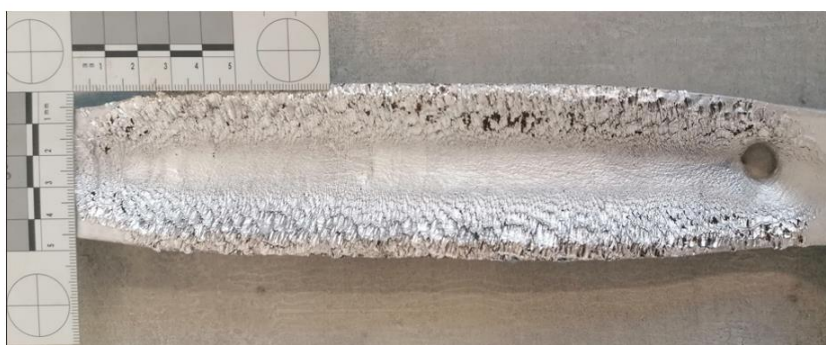
10. ábra: Alumínium tanulemez a stabil detonáció szemléltetésére 65
