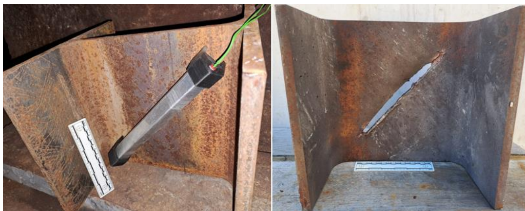
25. ábra: A lineáris vágótöltet elhelyezése és behatolása IPE 92 400 acélgerendába 93
