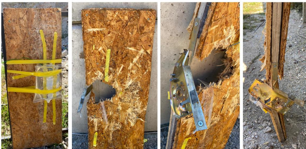
38. ábra: A nyílászáró imitáció szerkezete és a TKR munkavégző képessége 111
