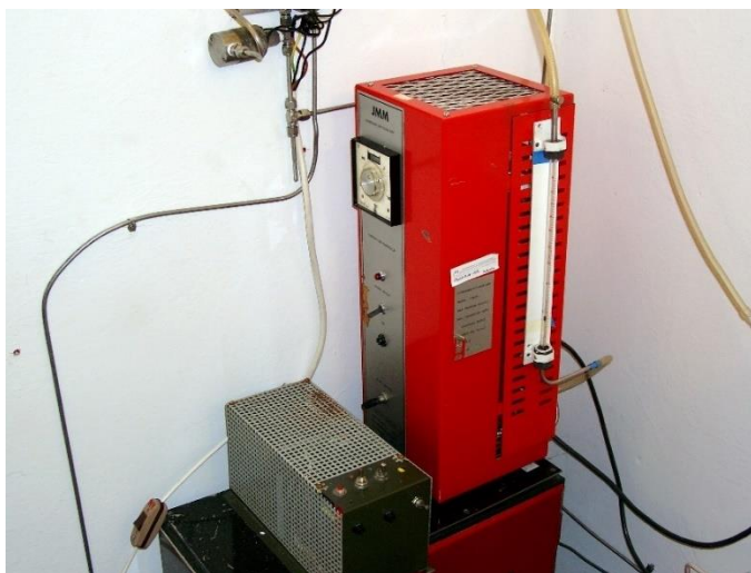
7.12. ábra. A kísérletekhez használt hidrogéntisztító berendezés
