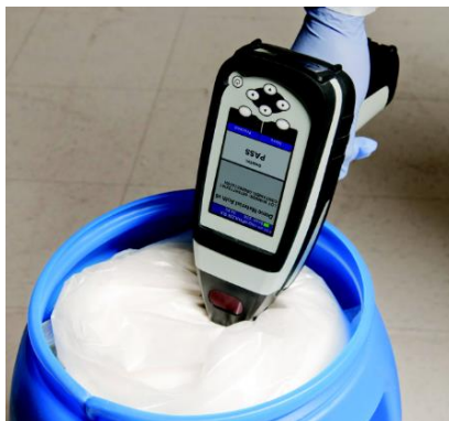
6.1. ábra. NIR tartományú hordozható spektroszkóp használat közben (illusztráció) [77]
