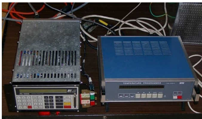
7.14. ábra. A kontroll berendezések: balra a mozgató elektronika, jobbra a programozható hőmérséklet vezérlő, a háttérben a transzformátor a fűtőelemhez
