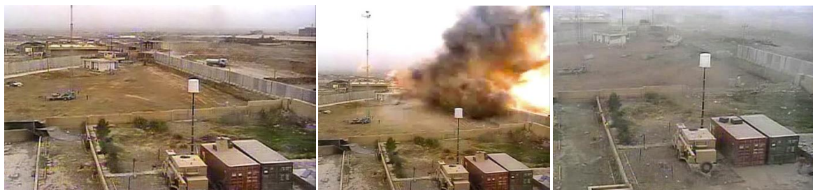
27. ábra - T-Wall típusú vasbeton védőfal tönkremenetele ( 63 ) – Irak
