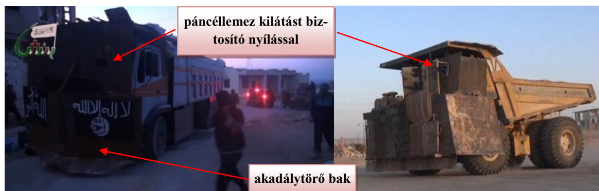
12. ábra – Házilag készített SVBIED páncélzatok a, Támadásra induló páncélozott SVBIED – Szíria (2012) b, Páncélozott bányászati billencs – Szíria (2015)
