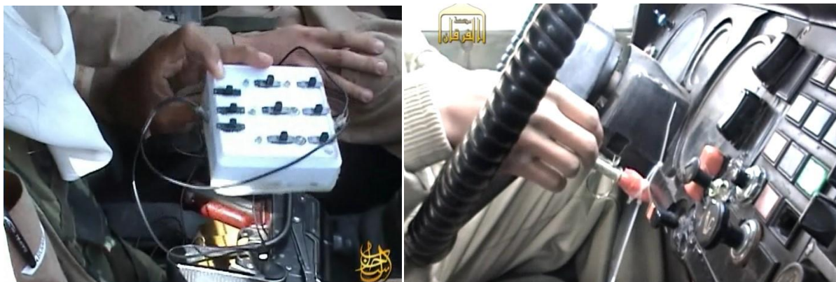
9. ábra - VBIED-t detonáló elektromos kapcsoló az utastérben - Afganisztán, Irak
