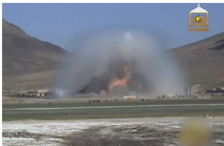
20. ábra - A lökeshullám félgömbszerű terjedését mutató pillanatnyi párafelhő
